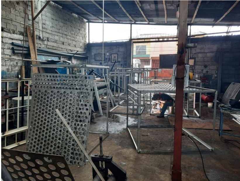
Figura 11.- Soldado de los ángulos de 1 ½” de acero inoxidable.
