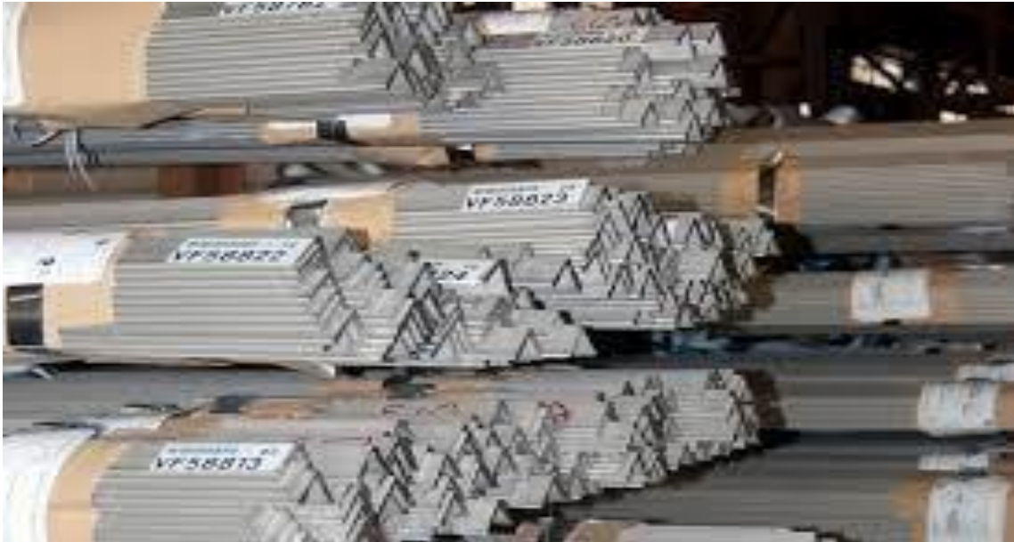
Figura 8.- Perfiles de ángulo de acero inoxidable de 50mm x 6mm x 600mm
