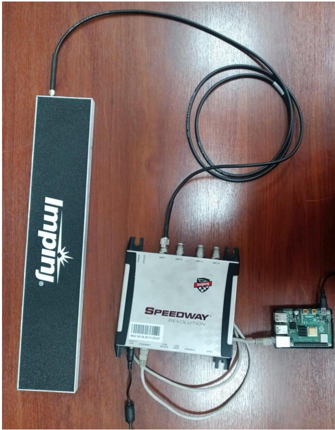
Fig. 7. Conexión de microcontrolador y antena al lector RFID
