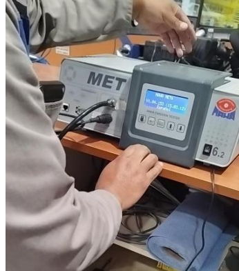
Figura 3.5. Encendido y calibración del analizador de partículas MET 6.2.
