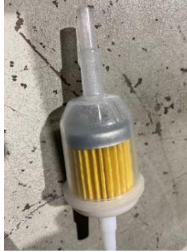
Figura 3.7. Filtro de combustible del analizador de partículas.
