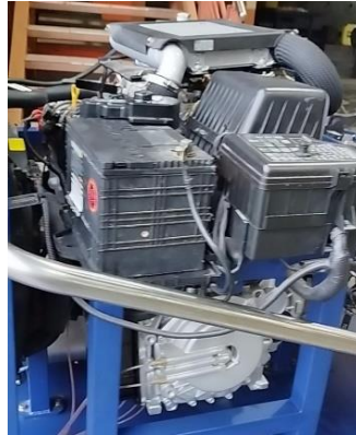
Figura 3.3. Revisión del estado de la batería y filtro de aire.
