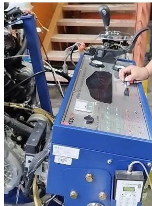
Figura 3.4. Prueba de encendido del motor de prueba Hyundai Santa Fe CRDI.
