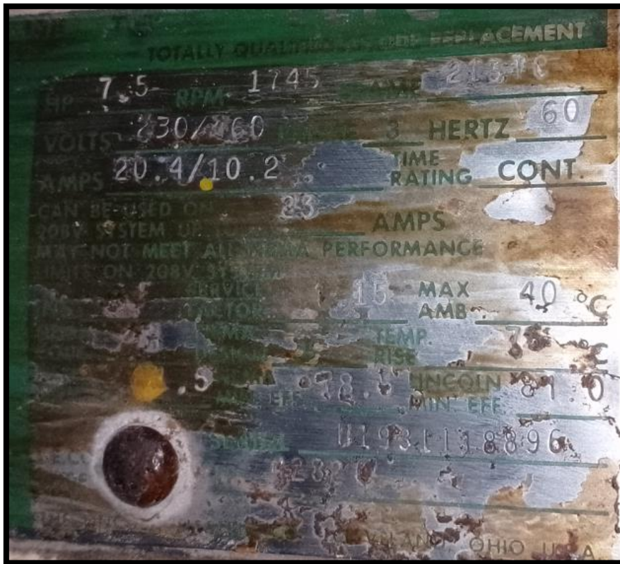
Figura 23. Placa de la Bomba Hidráulica de la marca LINCOLN de AC MOTOR® del “Molino Crusher”, fuente: Los Autores.
