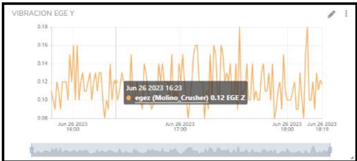
Figura 81. Sexto Paso: Curva del comportamiento que tiene la variable de la vibración en el eje Y del motor que se encuentra en el “Molino Crusher” en el área de “Molino de Reciclaje”, fuente: Los Autores.
