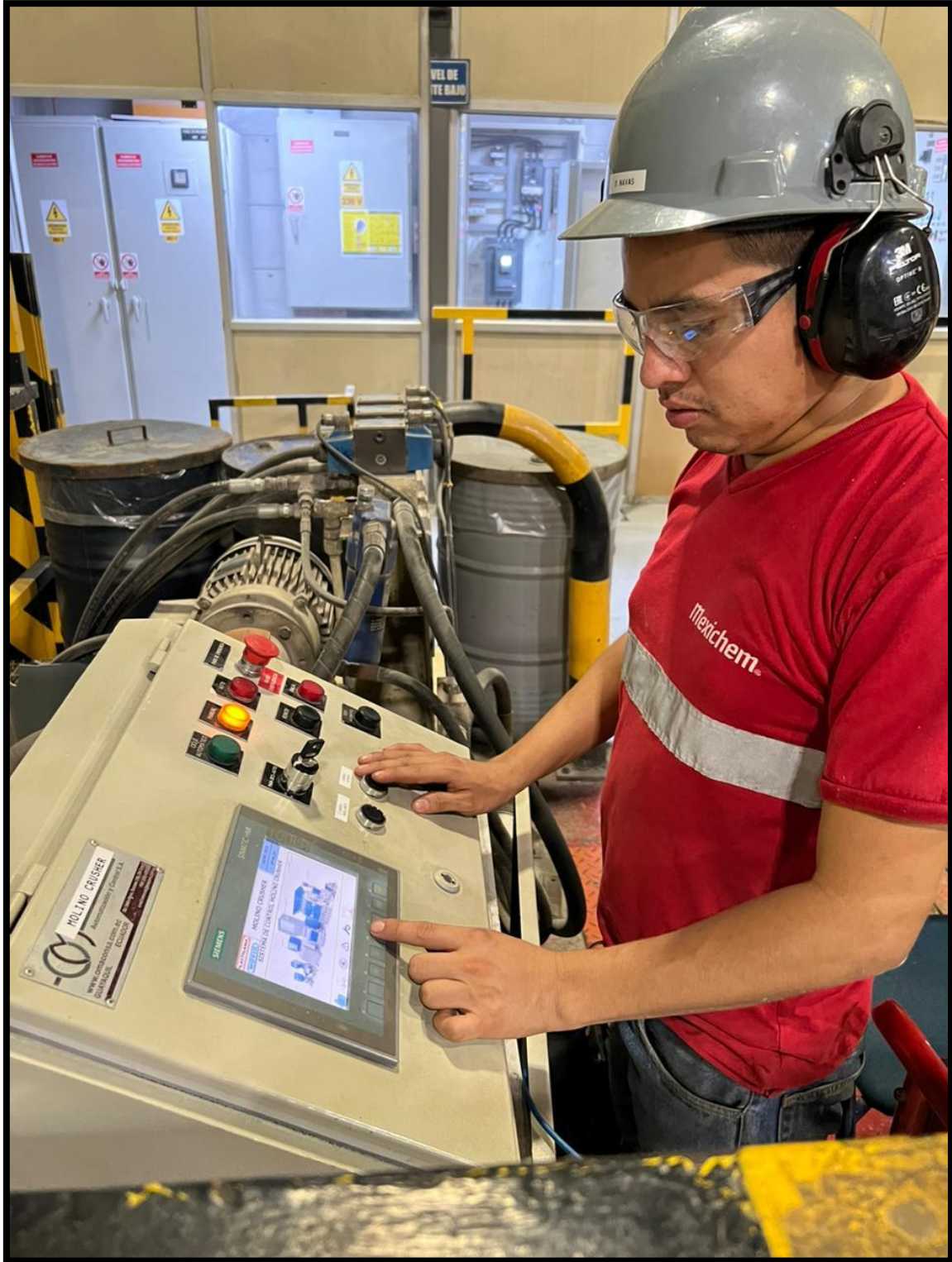
Figura 116. Comprobando el sistema en modo manual del “Molino Crusher” en el área de “Molino de Reciclaje”, fuente: Los Autores.
