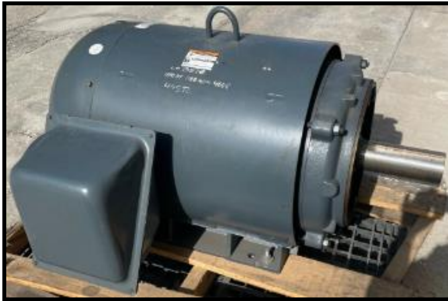
Figura 18. Motor principal LINCOLN de AC MOTOR® del “Molino Crusher”, fuente: (Electricmotors, 2023).
