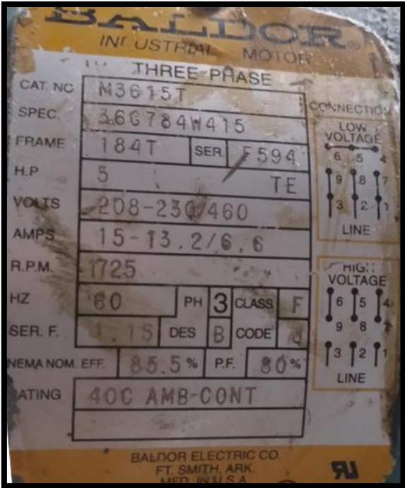
Figura 21. Placa del Motor tornillo de la marca BALDOR INDUSTRIA MOTOR® del “Molino Crusher”, fuente: Los Autores.
