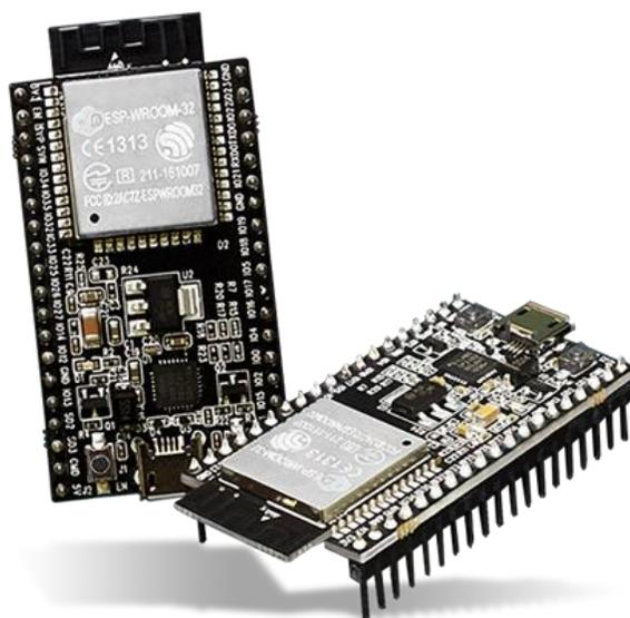
*Ilustración 6 Modulo ESP32*
