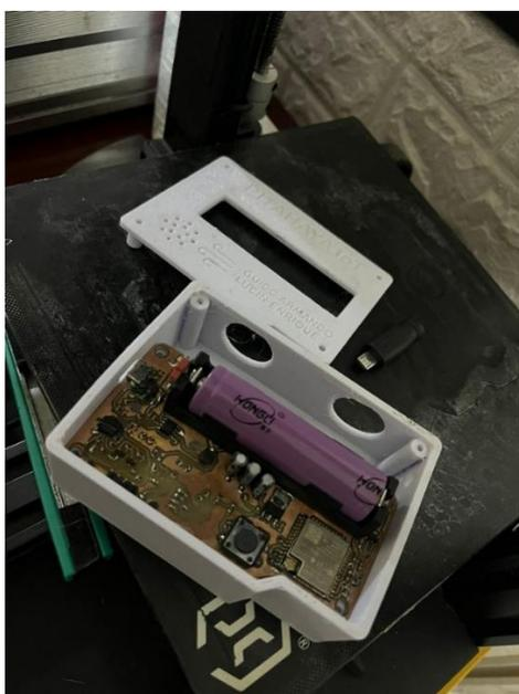
Figura 12 Caja del prototipo
