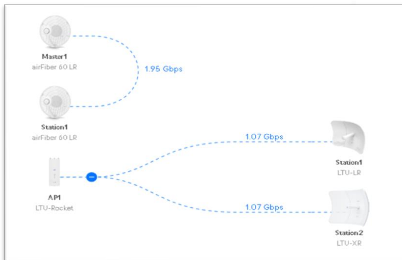
Figura 13. Topología del circuito, punto a punto.
