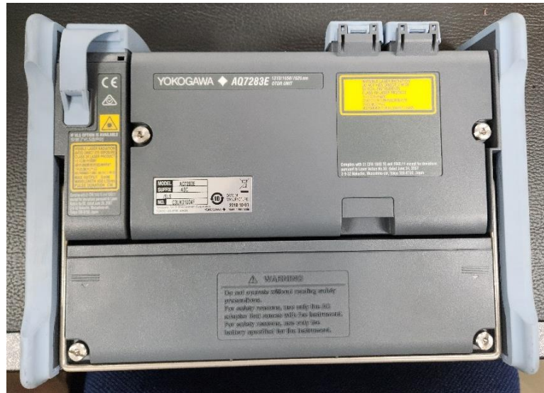
Figura 66. Parte posterior del YOKOGAWA AQ7280 OTDR (Optical time domain reflectometer - Reflectómetro en el dominio del tiempo óptico) donde está ubicado el YOKOGAWA AQ7283E. Fuente: [18].
