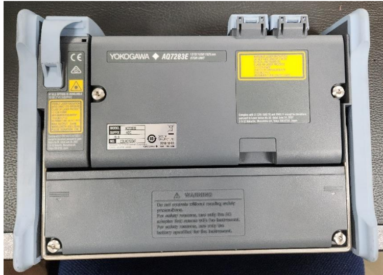
Figura 127. parte posterior del YOKOGAWA AQ7280 donde está ubicado el YOKOGAWA AQ7283E. Fuente: [19].
