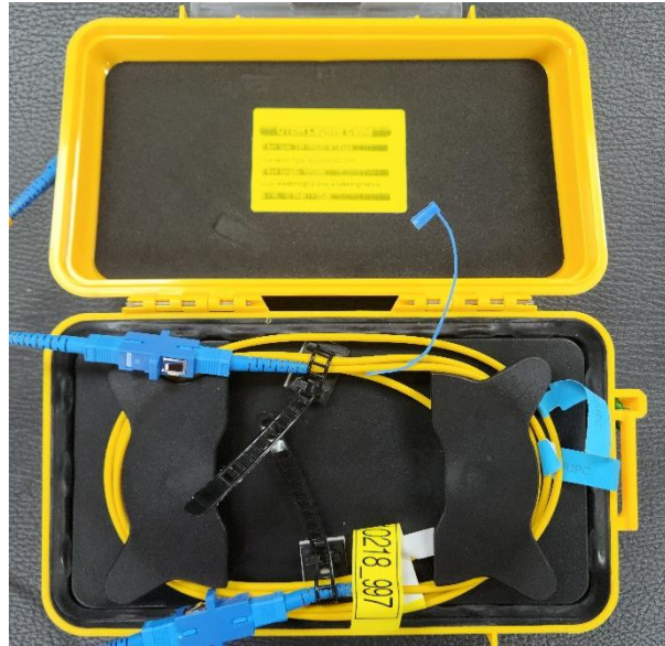
Figura 106. Cable de lanzamiento OTDR (Optical time domain reflectometer - Reflectómetro en el dominio del tiempo óptico). Fuente: [8].
