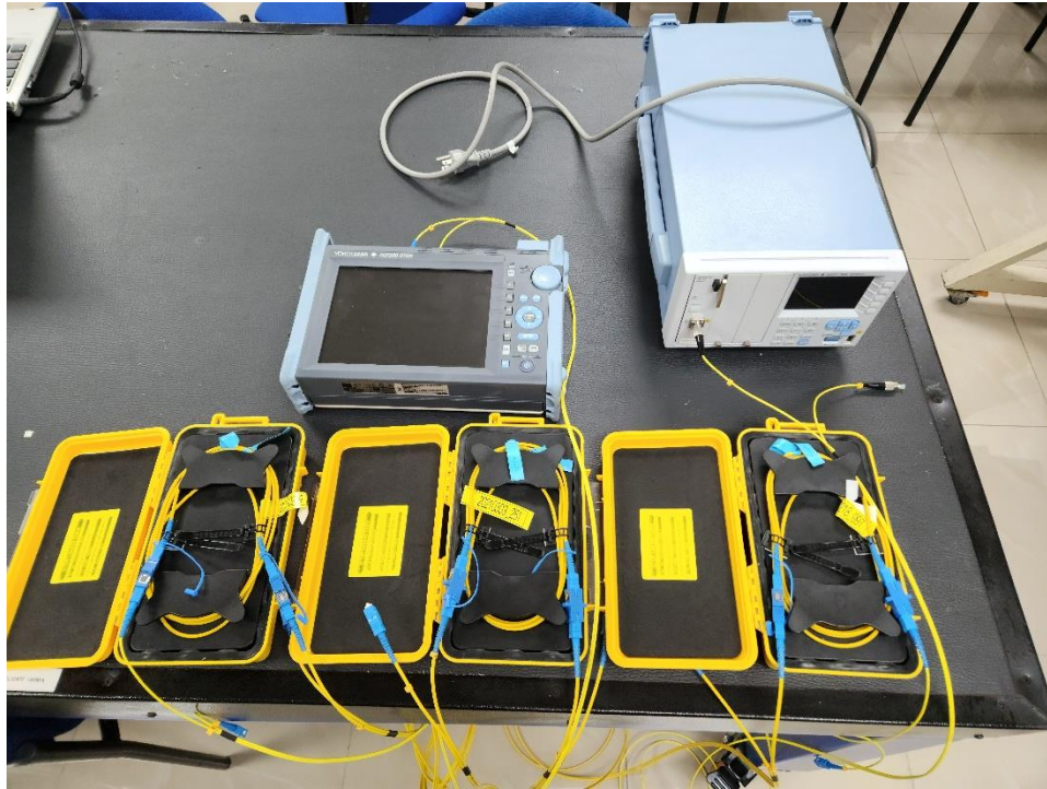
Figura 148. sistema óptico de 3km de cable de lanzamiento OTDR. Fuente: [18] [19] [8].
