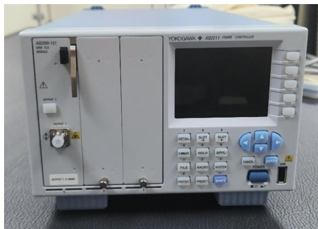
Figura 318. Controlador de Cuadros AQ2211. Fuente: [8].
