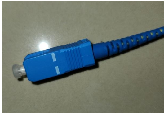
Figura 307. Conector SC (conector suscriptor). Fuente: [8].
