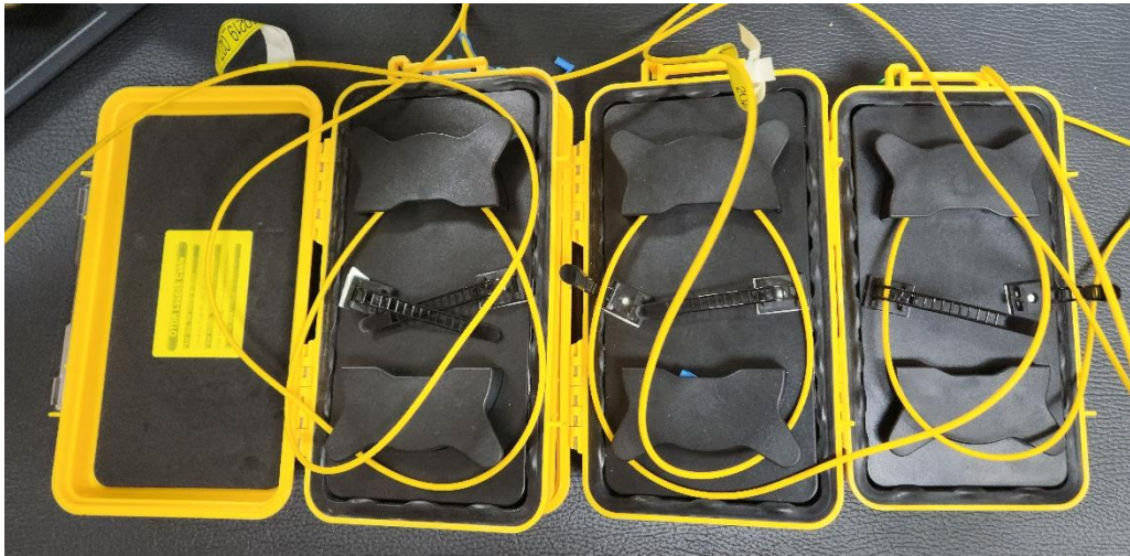
Figura 73. 3km cable de lanzamiento OTDR (Reflectómetro en el dominio del tiempo óptico) y sus conexiones. Fuente: [8].
