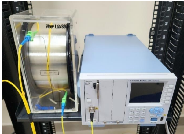
Figura 81. Conectar la fuente de luz AQ2200-131 con la fiber lab 800. Fuente: [8] [17].
