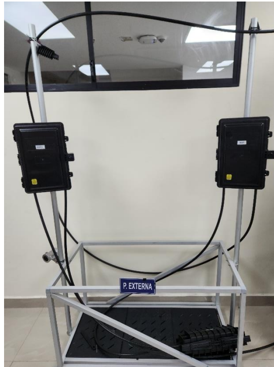
Figura 315. Red ODN (Red de distribución óptica). Fuente: [8]
