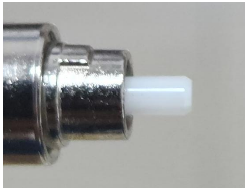
Figura 102. Pulido UPC (Ultra physical contact - Ultra contacto físico). Fuente: [8].
