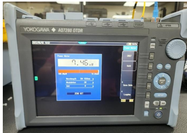
Figura 77. Interfaz módulo AQ7280 OPM en funcionamiento. Fuente: [18].
