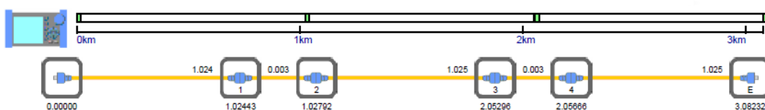
Figura 84. Eventos detectados y localizados por el OTDR en el medio óptico de 3 [km]. Fuente: [18].
