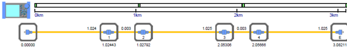
Figura 231. Mapa de eventos realizado por el reflectómetro.
