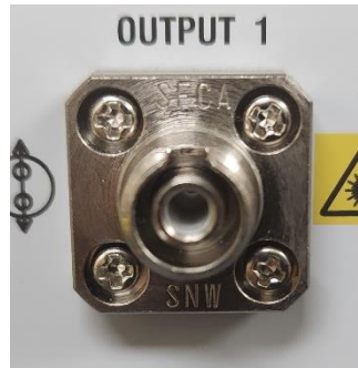
Figura 121. Puerto FC (Ferrule Connector - Conector Ferrule). Fuente: [18].
