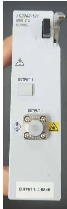
Figura 119. Parte frontal del módulo AQ2200-131. Fuente: [18]
