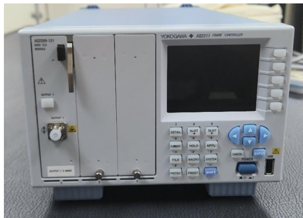
Figura 108. Cara anterior del sistema de prueba de aplicaciones múltiples YOKOGAWA serie AQ2211. Fuente: [18].
