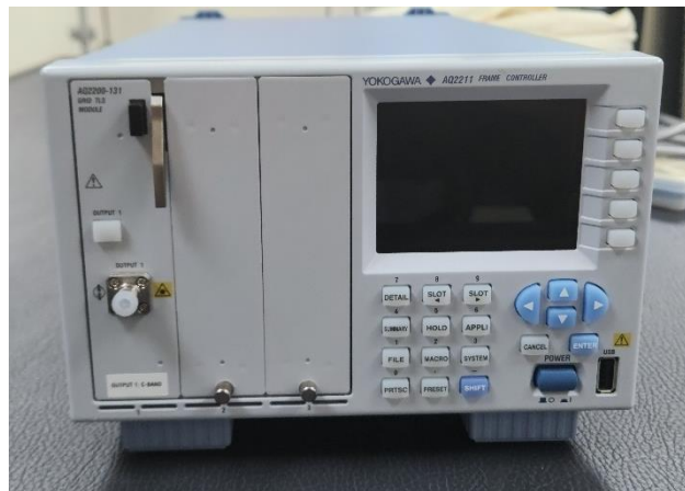
Figura 310. Controlador de Cuadros. Fuente: [18].
