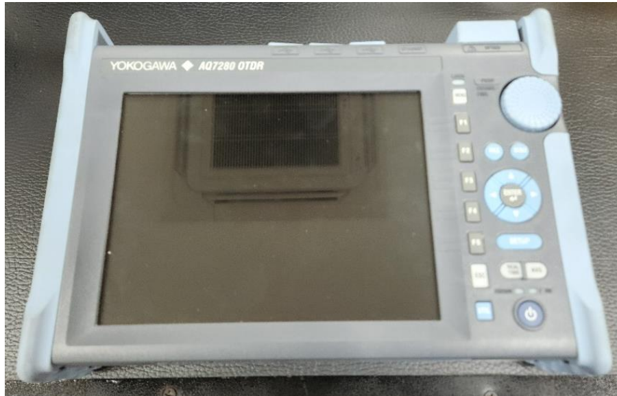
Figura 64. Parte frontal de YOKOGAWA AQ7280 ODTR (Reflectómetro en el dominio del tiempo óptico). Fuente: [18].
