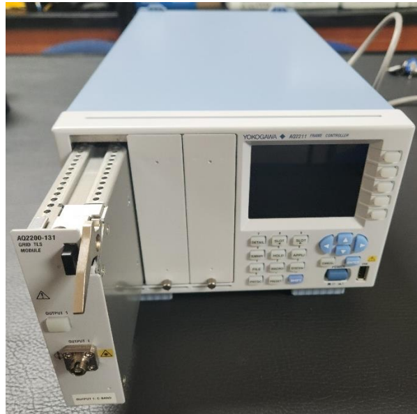
Figura 74. Instalación del YOKOGAWA módulo AQ2200-131 en el controlador de cuadros. Fuente: [17].
