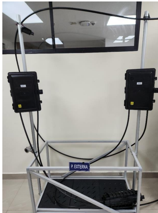
Figura 316. Red de distribución óptica. Fuente: [8].
