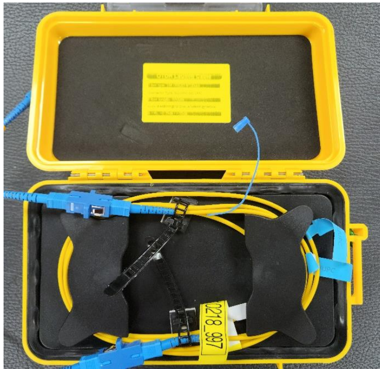
Figura 35. Cable de lanzamiento OTDR (Optical time domain reflectometer - Reflectómetro en el Dominio del Tiempo Óptico). Fuente: [8].
