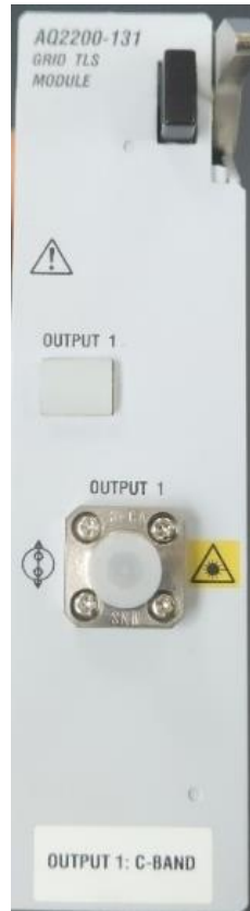
Figura 51. Parte frontal del módulo AQ2200-131. Fuente: [17]
