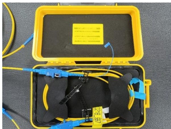
Figura 71. 1km cable de lanzamiento OTDR (Reflectómetro en el dominio del tiempo óptico) y sus conexiones. Fuente: [8].
