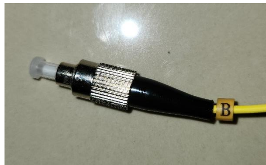
Figura 105. conector FC (Ferrule Connector - Conector Ferrule). Fuente: [8].
