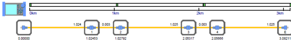
Figura 186. Eventos realizados por el reflectómetro. Fuente: [19].
