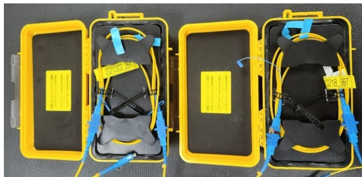
Figura 72. 2 [km] cable de lanzamiento OTDR (Reflectómetro en el dominio del tiempo óptico) y sus conexiones. Fuente: [8].
