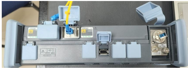
Figura 70. Conexión de un extremo de fibra óptica mono modo al puerto de nombre 'OTDR fuente de luz estabilizada'. Fuente: [8] [18].
