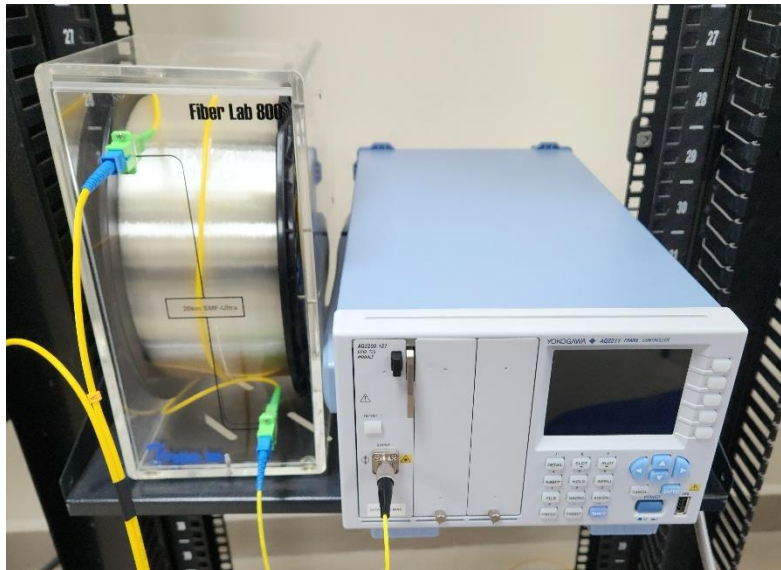
Figura 313. Conectar la fuente de luz AQ2200-131 con la fiber lab 800. Fuente: [8] [18].
