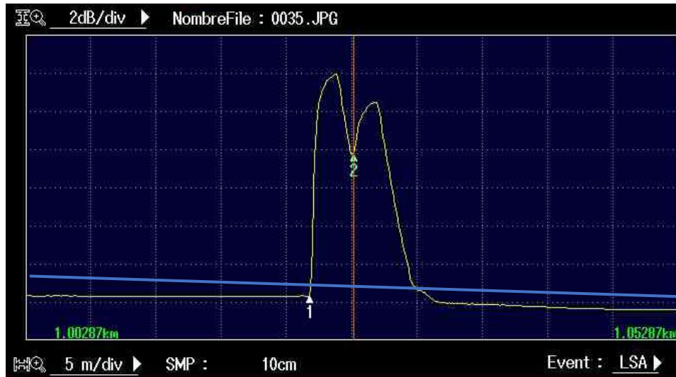
Figura 208. El cursor de color azul referencia un nivel de 0.5 [dB], paralelo a la pendiente negativa de pérdidas de potencia del segundo kilómetro. Fuente: [19].
