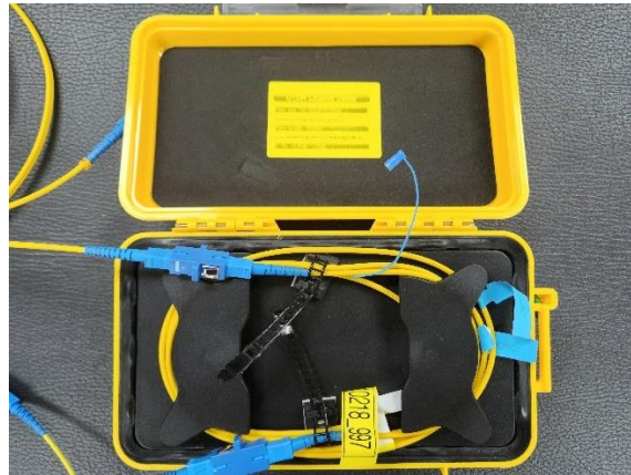
Figura 308. Cable de lanzamiento de 1 [km]. Fuente: [8].
