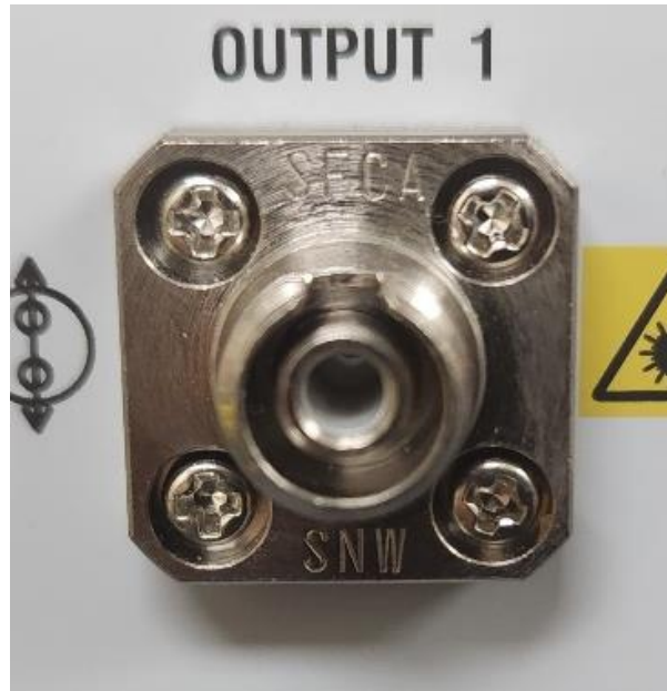
Figura 54. Puerto FC (Conector Ferrule). Fuente: [17].
