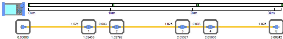
Figura 204. Mapa de eventos realizado por el reflectómetro. Fuente: [19].
