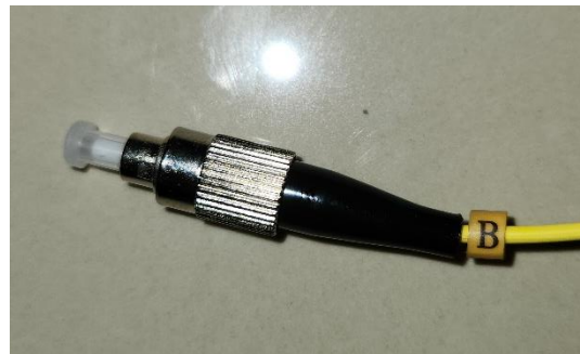
Figura 306. Conector FC (Conector Ferrule). Fuente: [8].
