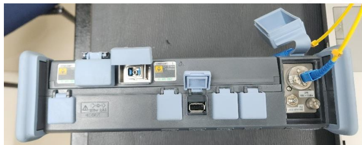
Figura 76. Conexión de la fibra óptica mono modo de 3[m] al puerto de nombre 'OPM' del AQ7280E. Fuente: [8] [18].
