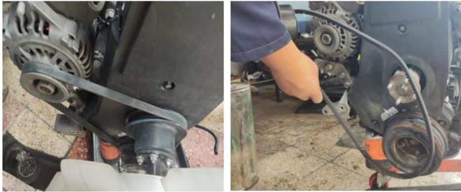
Figura 2.33 Revisión de la correa de accesorios
