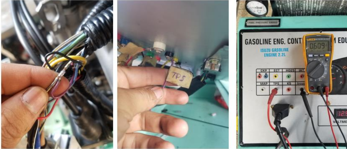
Figura 2.61 Cableado y comprobación de señal sensor TPS.
