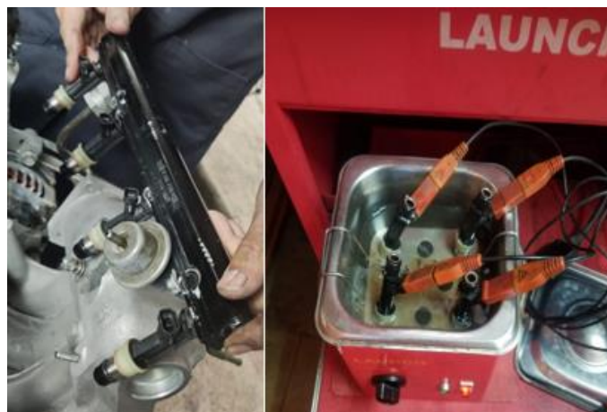
Figura 2.21: Mantenimiento de inyectores.
