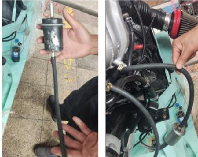
Figura 2.20: Cambio de mangueras y filtro de combustible.
