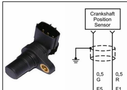
Figura 3 Diagrama del sensor CKP. Fuente: (Isuzu Motors, 2004)
