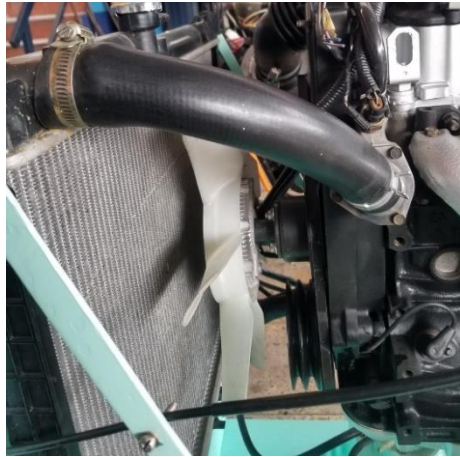
Figura 2.27. Mangueras de refrigeración.
