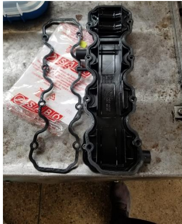
Figura 2.29 Reemplazo de empaque del tapa válvulas
