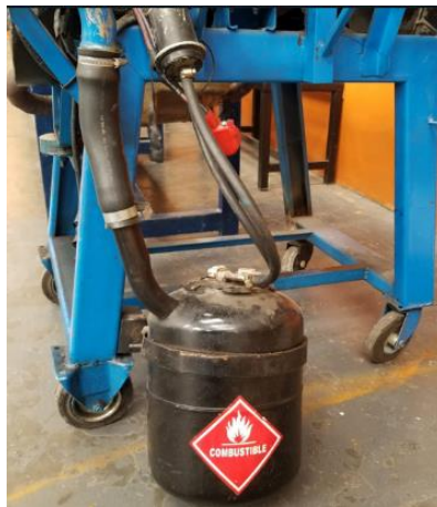
Figura 2.17: Depósito de combustible motor Isuzu 2.2.
