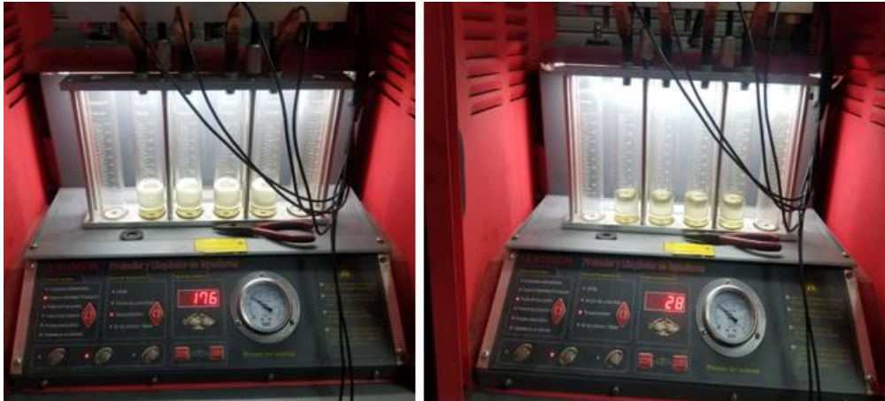
Figura 2.22: Pruebas de inyectores.
