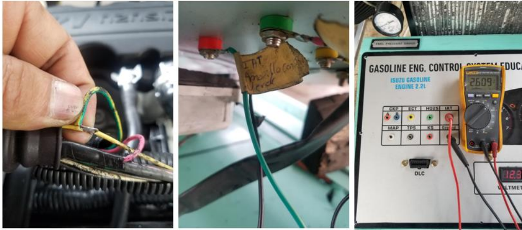
Figura 2.65 Cableado y comprobación de señal sensor IAT.
