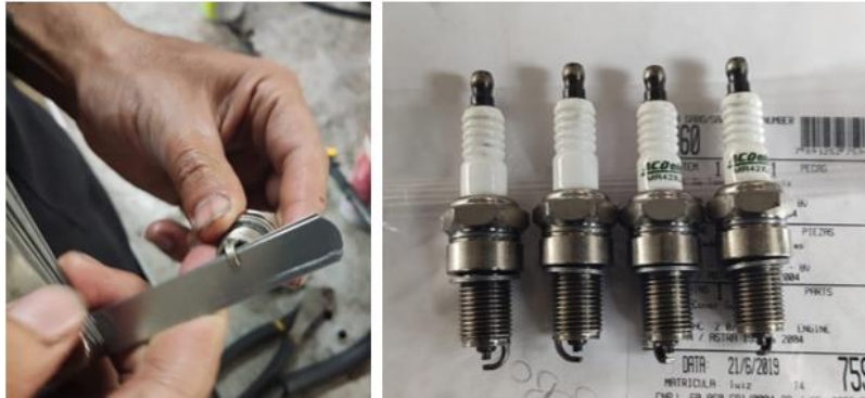
Figura 2.35 Calibración de las bujías.
