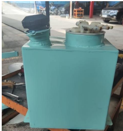
Figura 2.18 Depósito de combustible listo.
