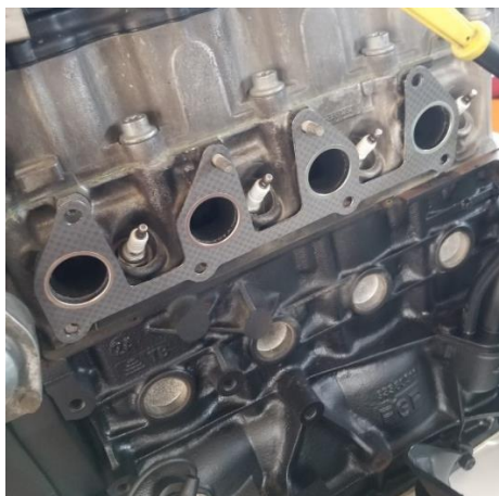
Figura 2.30 Cambio del empaque de escape
