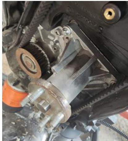
Figura 2.25 Bomba de agua.
