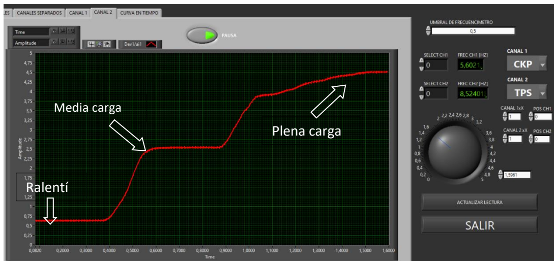
Figura 3.22 Señal del sensor TPS a ralentí, media carga, plena carga.
