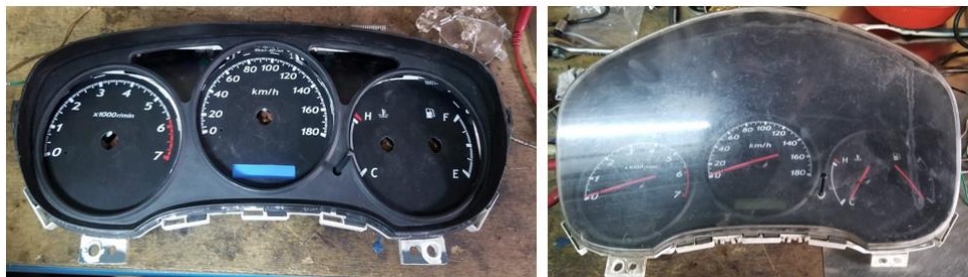
Figura 2.13 Reparación de medidores.
