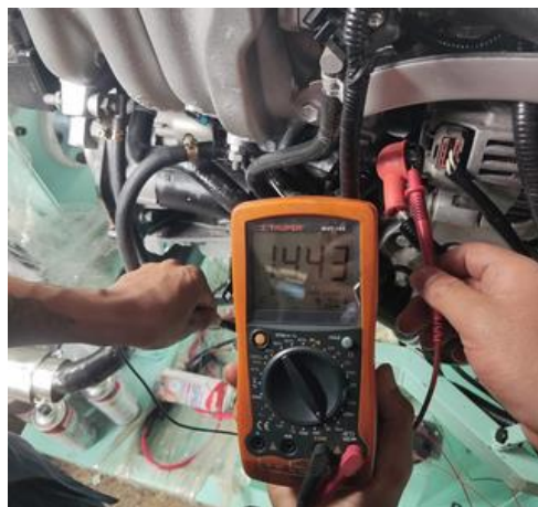
Figura 2.15 medición de voltaje del alternador.
