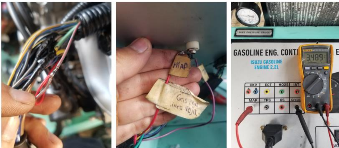
Figura 2.59 Cableado y comprobación de señal sensor MAP.
