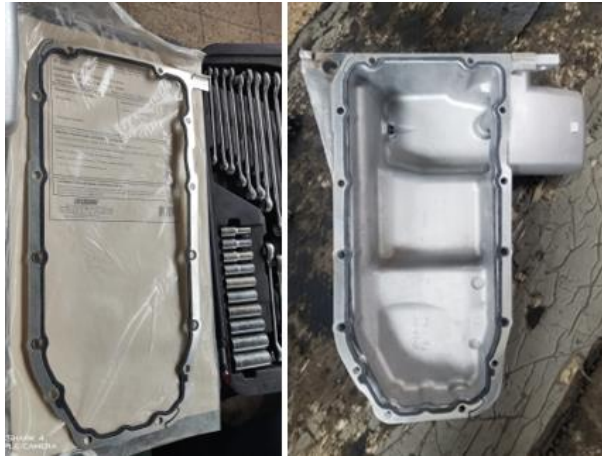
Figura 2.31 Colocación del empaque del cárter
