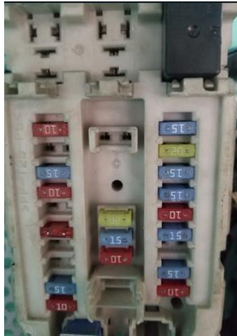
Figura 2.14 Caja de fusibles motor Isuzu 2.2
