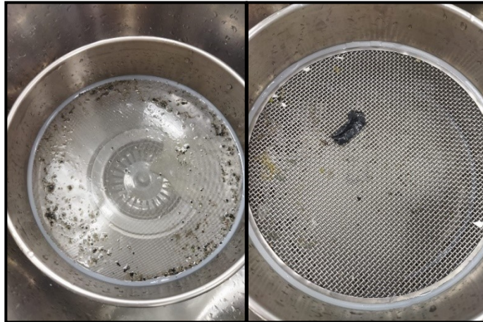
Figura 18. Filtración gruesa de la muestra de agua
