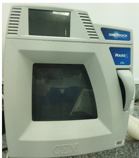
Figura 13. Equipo de digestion por microondas “MARS 6” modelo 230/60 de la marca CEM
