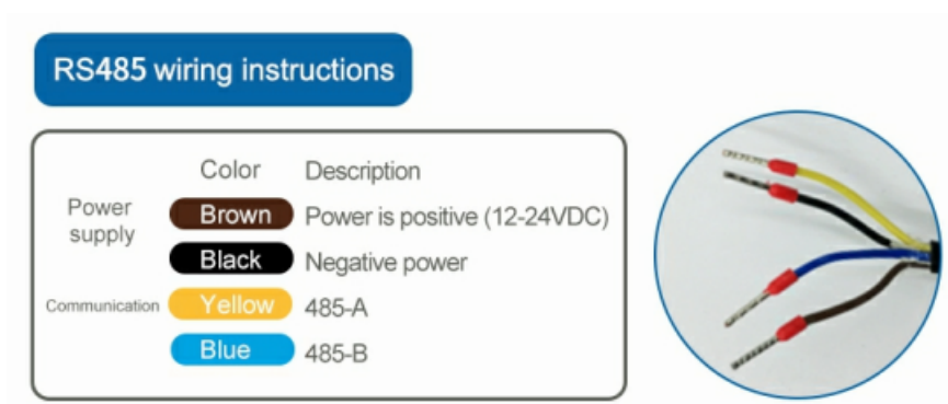
Figura 2.3: Cableado Sensor NPK.
