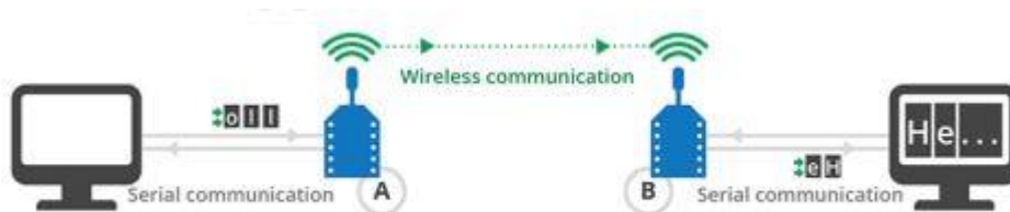
Figura 2 Modelo esquemático de comunicación punto a punto con dos Xbee(aprendiendoarduino.wordpress.com,2016)
