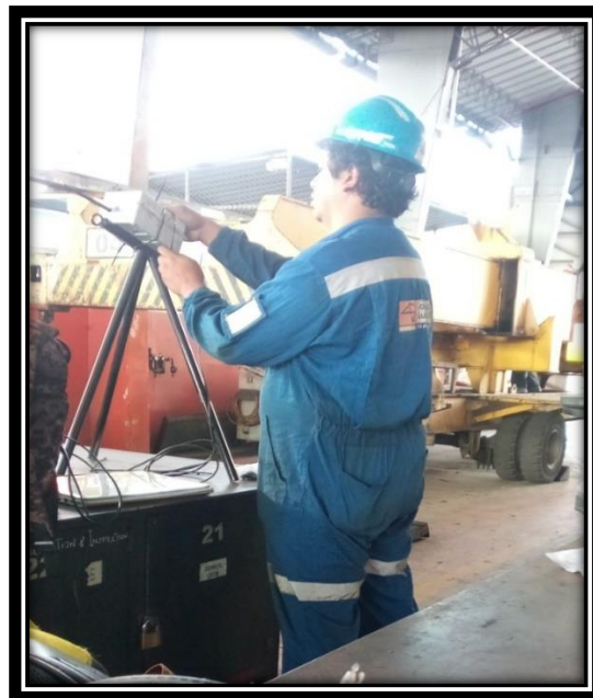
Figura 22 Colocación del módulo Xbee junto a su caja en el trípode
