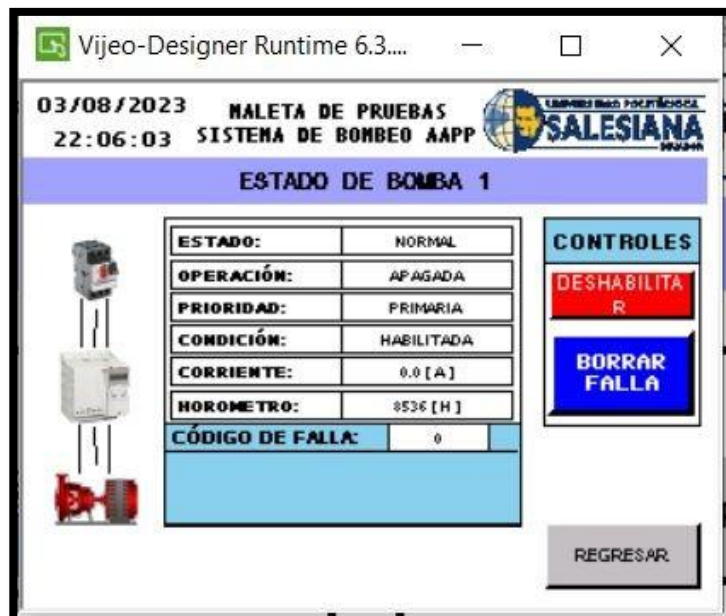
Fig.60 Pantalla Estado bomba
