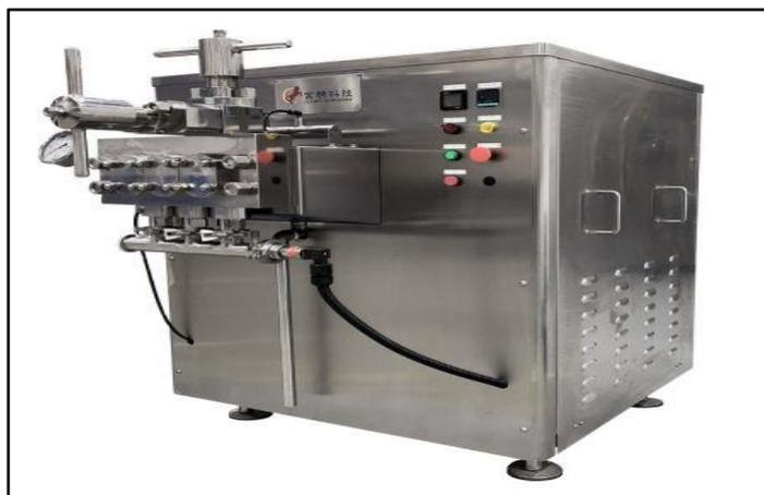
*Ilustración 5: Homogeneizadora de alimentos*
