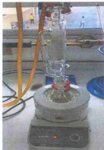
Figura 12 Manta calefactora a 100 C
