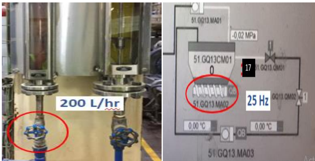
Figura 11. Pasos del 14 al 17 para el proceso de arranque del extrusor
