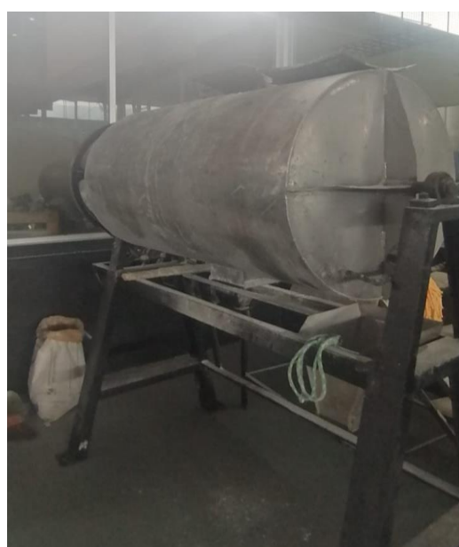
ANEXO 12: REACTOR DE MEZCLAS DE POLVOS HORIZONTAL EN AREA DE PRODUCCION
