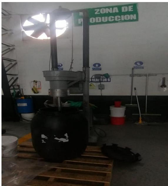
ANEXO 5: AGITADOR INDUSTRIAL (REACTOR 6) EN USO DE PROCESO QUIMICO EN AREA DE PRODUCCION
