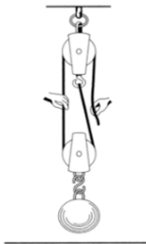
Figura 1.2 Esquema de un polipasto de dos rodillos
