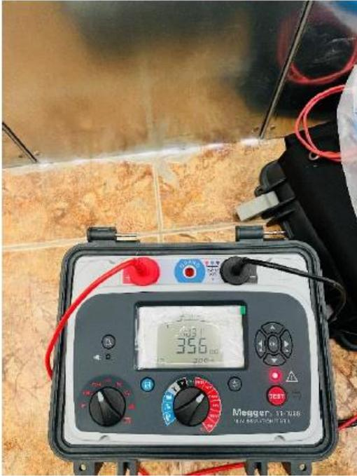
Figura 19 Pruebas de aislamiento
