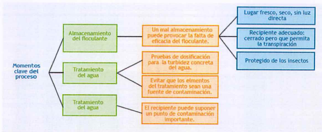
Ilustración 3. Cuadro conceptual sobre los momentos importantes en el proceso del uso de la M. oleifera como coagulante natural.
