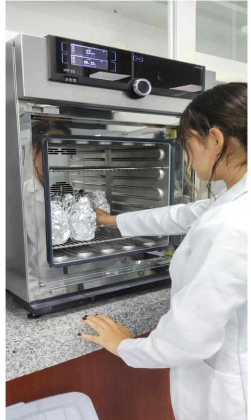
Ilustración 106: Incubación de las muestras recolectadas DBOs
