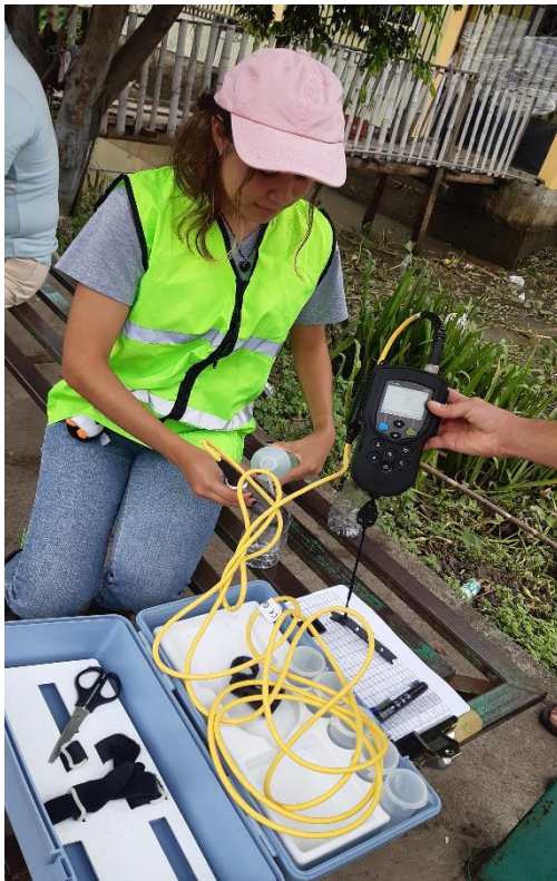
Ilustración 100: Lectura de Oxígeno disuelto In situ
