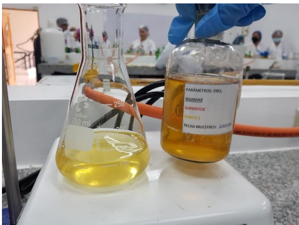
Ilustración 93: Titulación de las muestras para determinación de DBO 5
