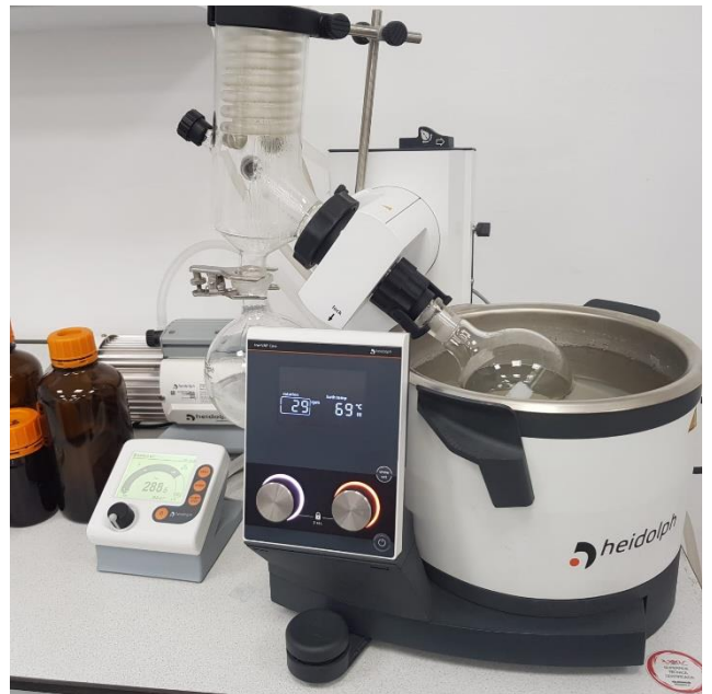
Ilustración 88: Separación del solvente (cloroformo) mediante el rotavapor, para determinación de aceites y grasas
