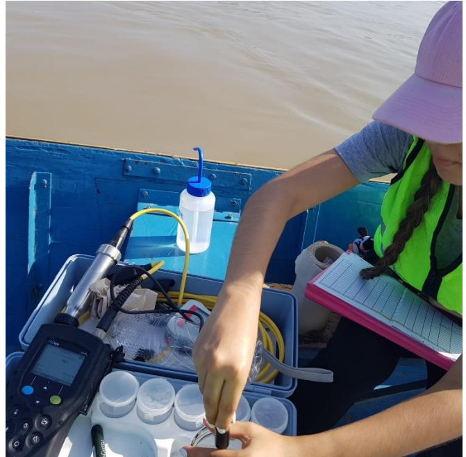
Ilustración 99: Medición de pH (In situ)
