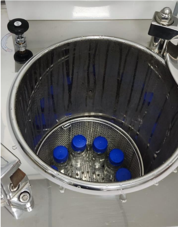
Ilustración 83: Esterilización de botellas de vidrio, previo a muestreo de Coliformes Totales
