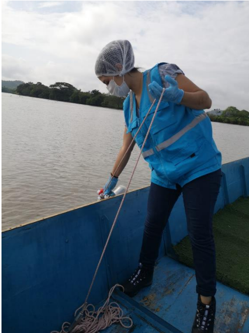
Ilustración 98: Recolección - muestra de agua mediante botella Van Dorn
