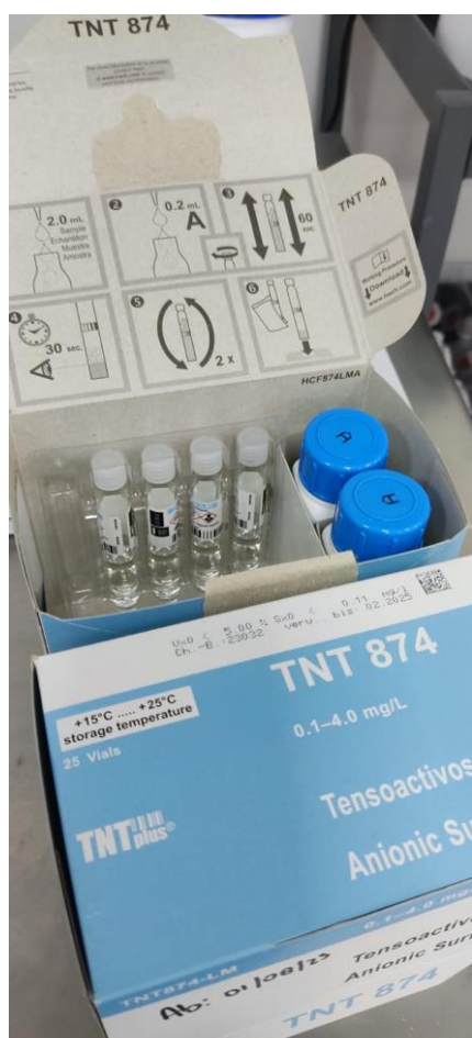
Ilustración 107: Análisis de Tensoactivos en el laboratorio SGS, mediante el uso de viales
