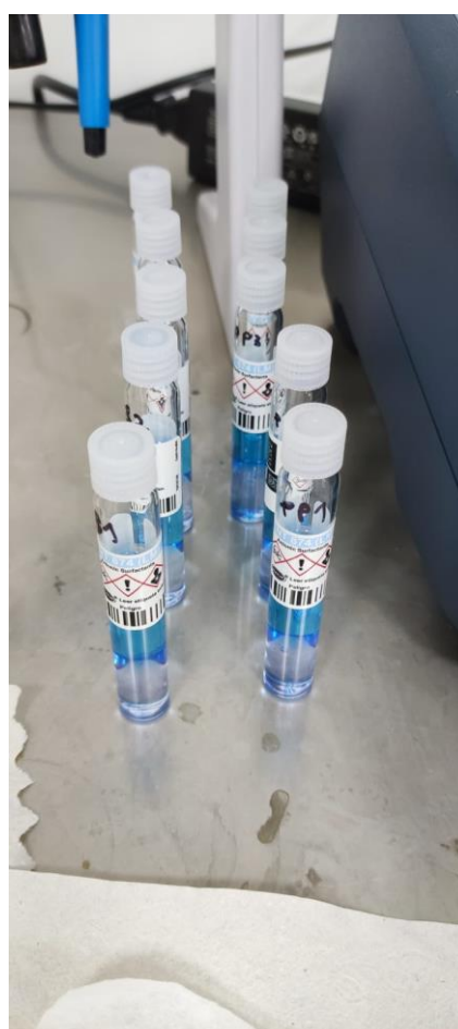
Ilustración 107: Análisis de Tensoactivos en el laboratorio SGS, mediante el uso de viales
