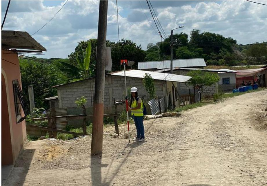
*Ilustración 23 Punto con el prisma topográfica.*
