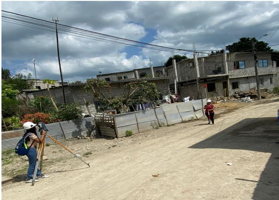
*Ilustración 24 Medición con la estación total.*
