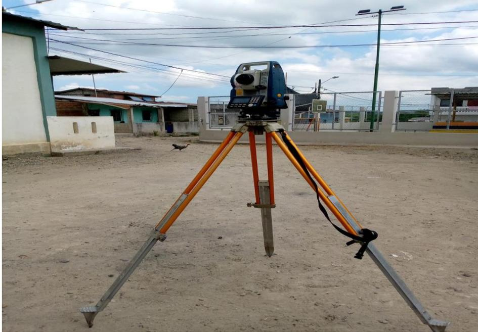
*Ilustración 19 Topografía con la estación total.*
