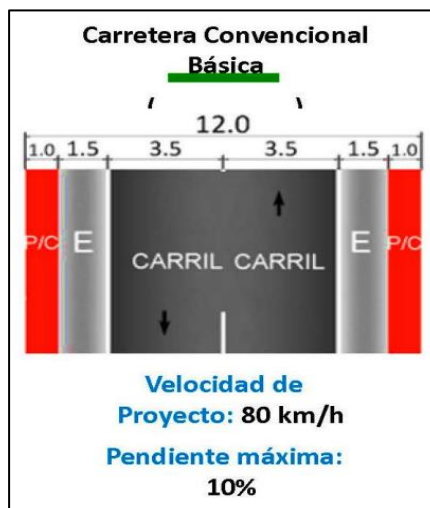
Ilustración 7 Carretera Convencional Básica
