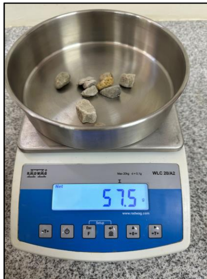
Ilustración 81 Material Contenido en Tamiz 1/2”
