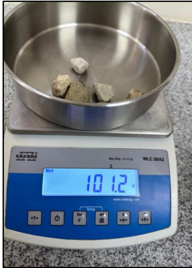
Ilustración 80 Material Contenido en Tamiz de 3/4”
