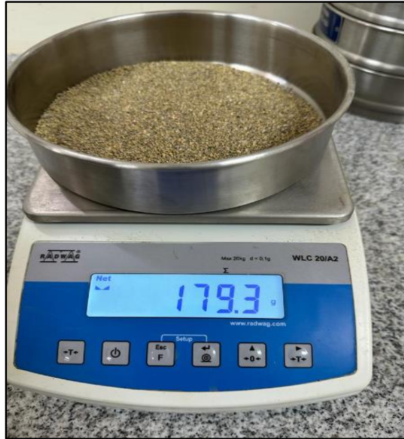
Ilustración 84 Material Contenido en Tamiz 10
