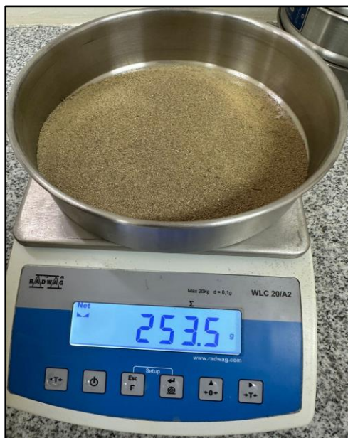
Ilustración 85 Material Contenido en Tamiz 40
