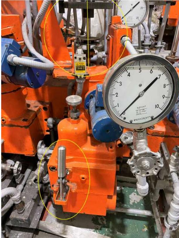
**Nota:** Fotografía en la que se puede observar el desgaste en el manipulador e incorrecta alineación con el mismo, a la izquierda se encuentra la palanca de disparo, mal sujeta debido al desgaste de los materiales.
