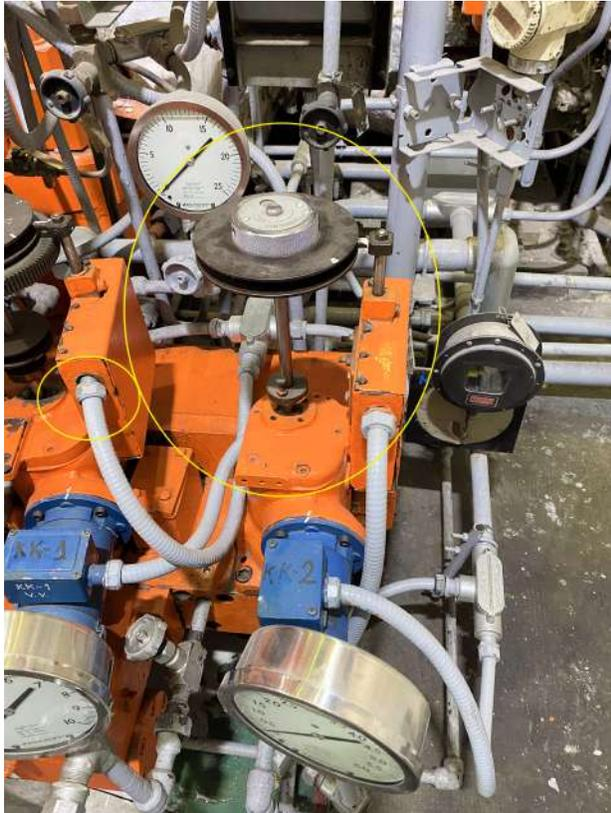
**Nota:** Fotografía en la que se puede observar el desgaste en el manipulador del acelerométrico, en el vástago que esta unido al sistema y elementos con falta de fijación.
