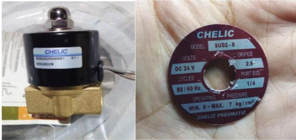
Figura 9. Cambio de válvula de desagüe
