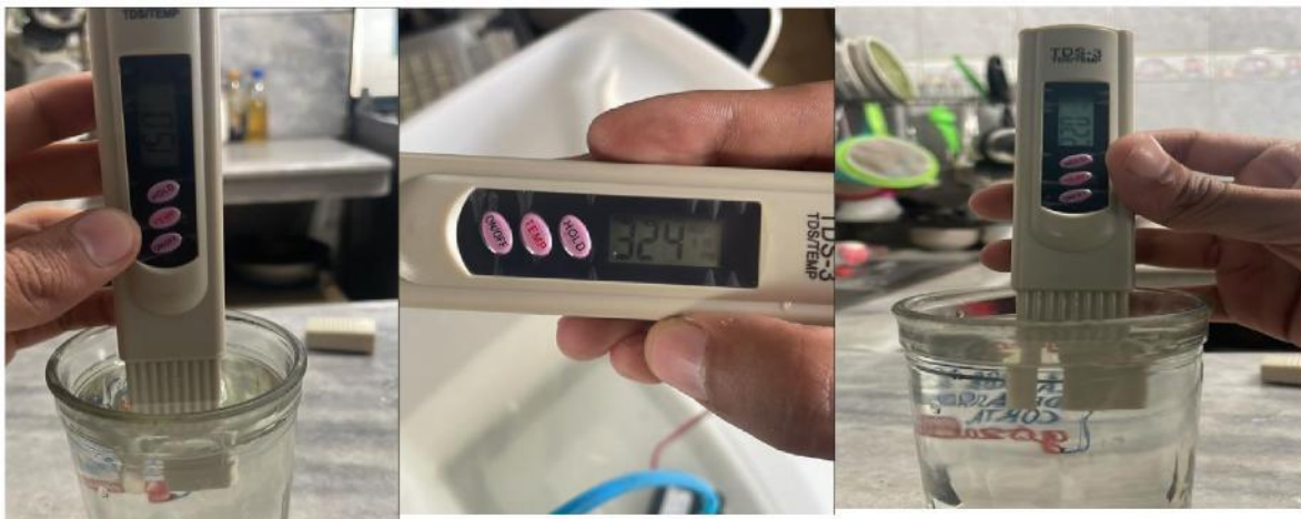
Figura 16. Mediciones que comprobaron un scaling
