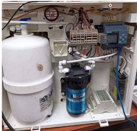
Figura 5. Prototipo luego de las modificaciones.
