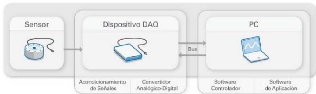
Figura 2: Diagrama de un sistema con Daq o Das (Agüero, 2017)
