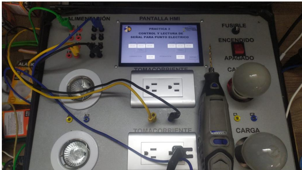
Figura 94:. Activación de punto eléctrico mediante pantalla nextion – Práctica 2
