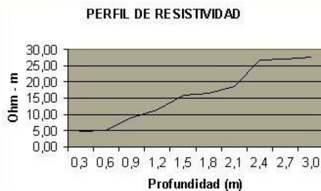
Figura 19 Perfil de resistividad para zona con capa superficial arcillosa y húmeda y capa inferior rocosa
