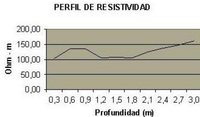
Figura 21 Perfil de resistividad para Zonas con terreno rocoso y seco
