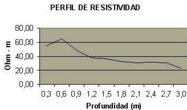
Figura 20 Perfil de resistividad para zonas con capa superficial muy seca, capa inferior arenosa
