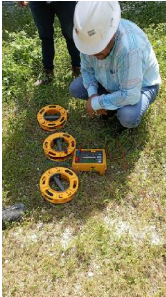
ANEXO 4 Mediciones en diferentes puntos del terreno
