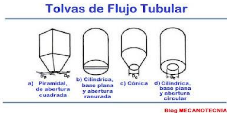
Figura 7. Tolvas de flujo tubular [5].
