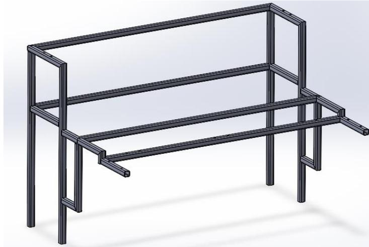
**Figura 33.** Estructura metálica de la máquina dosificadora de chocolates.
