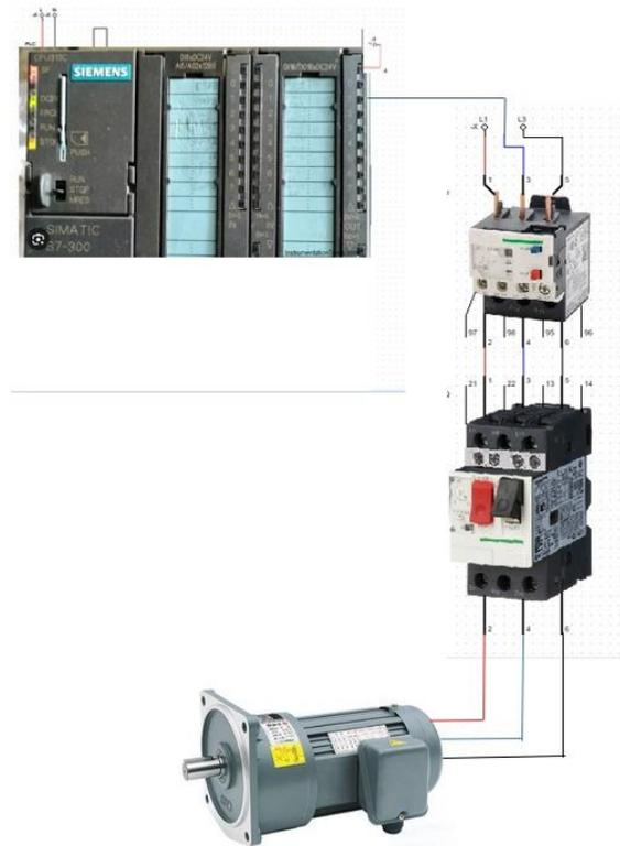
Figura 43. Esquema de conexión CadeSimu Motor Reductor.
