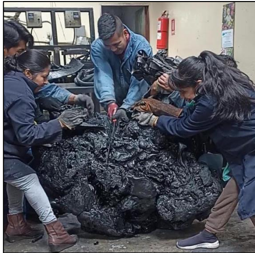
Fig. 6 Corte manual de caucho.
