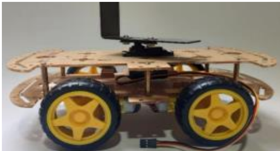
Figura 29 :Montaje de la base sobre la estructura
