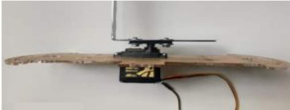
Figura 28 :Base del sensor LIDAR
