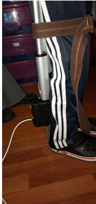
Figura 47 Actuador lineal ensamblado a eslabones
