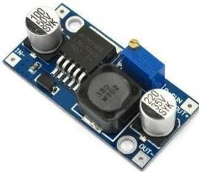
Es un dispositivo como regulador de voltaje a través de un potenciómetro:
