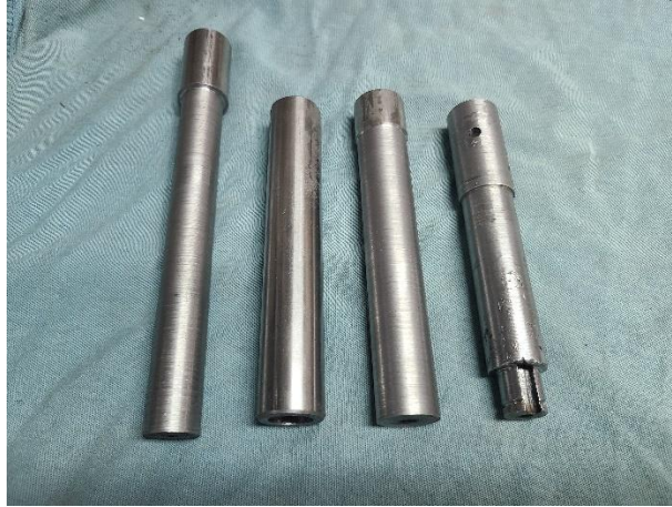
Figura 42 Ejes descartados por mal funcionamiento. El autor.
