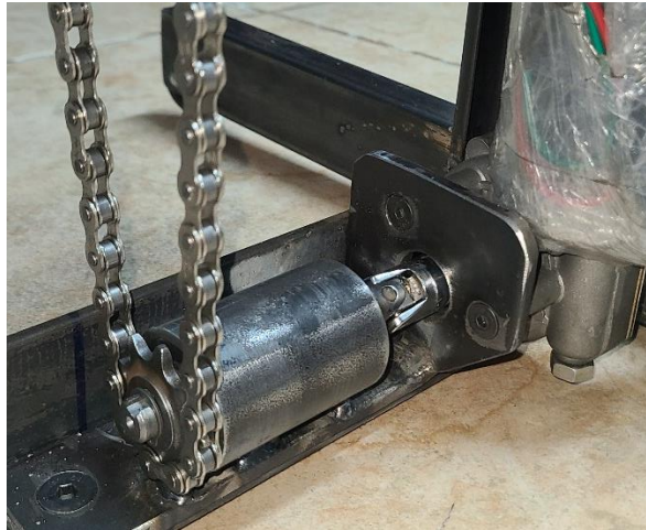
Figura 45 Mecanismo de transferencia de potencia del elevador. El autor.
