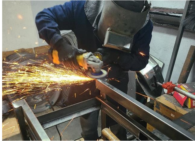
Figura 33 Proceso de desbaste y pulido en las tapas de tubo rectangular. El autor.
