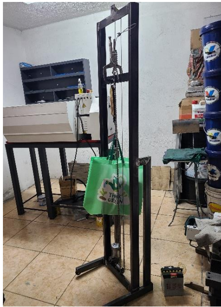
Figura 49 Pruebas de elevador con carga de 15 kg. El autor.
