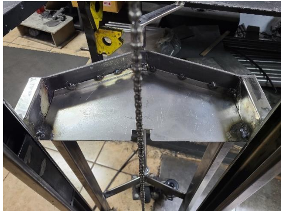
Figura 53 Compartimiento para dispositivos de control. El autor.
