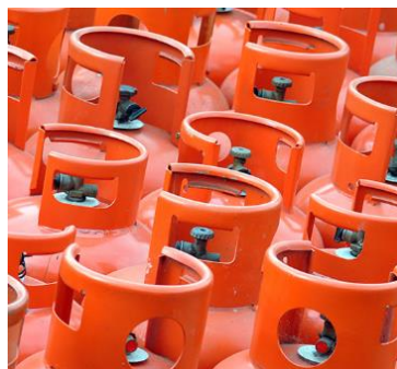
Fig. 3 Cilindros de gas donde se almacena el GLP en estado líquido. [16]
