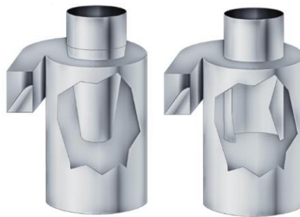
Figura 9. Esquemas del tubo interno de descarga cónico y cilíndrico de un ciclón [31].
