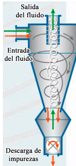
Figura 3. Esquema del funcionamiento de un separador ciclónico [26].
