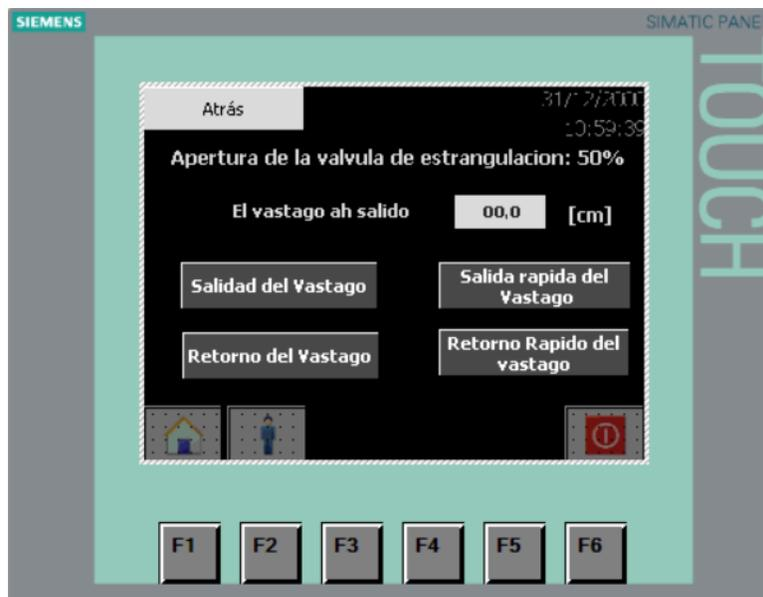
**Nota:** El entorno de calibración cuenta con botones para salida y retorno del vástago de forma continua y por pulsos, además se indica la posición en la que el vástago se encuentra con respecto a un punto configurado. Elaborado por autores.
