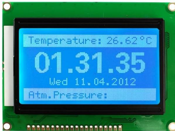
*Figura 2.2 Display LCD de resolución 128 x 64 píxeles*
