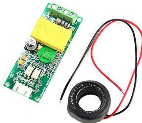
Figura 2.3 Dispositivo sensor PZEM-004T
