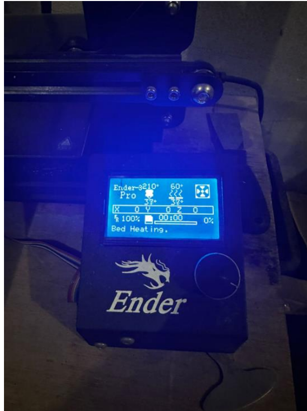
Fig. 92. Monitoreo de los parámetros de temperatura en la impresora 3D.
