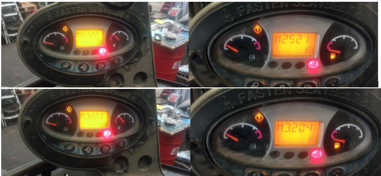
Fig. 104. Codigos de fallo presentados en la miniexcavadora por falla del actuador.
