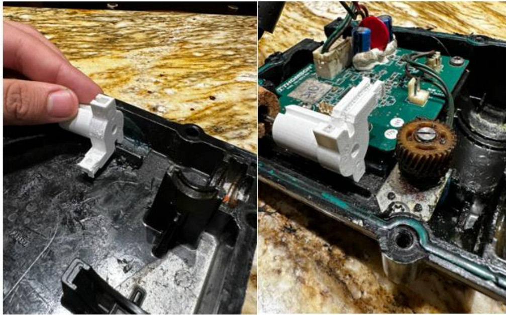
Fig. 106. Posición del husillo rediseñado en la carcasa del actuador.
