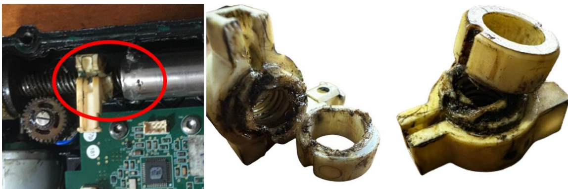
Fig. 20. Husillo de bloqueo fracturado.
