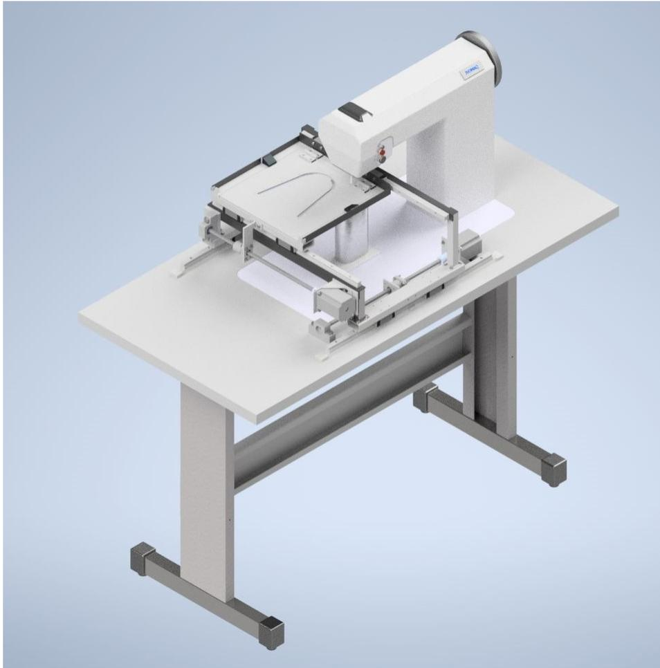
**Nota:** Se observa la adaptación del diseño del sistema CNC a la máquina industrial de costura IVOMAQ serie IVM 55.
