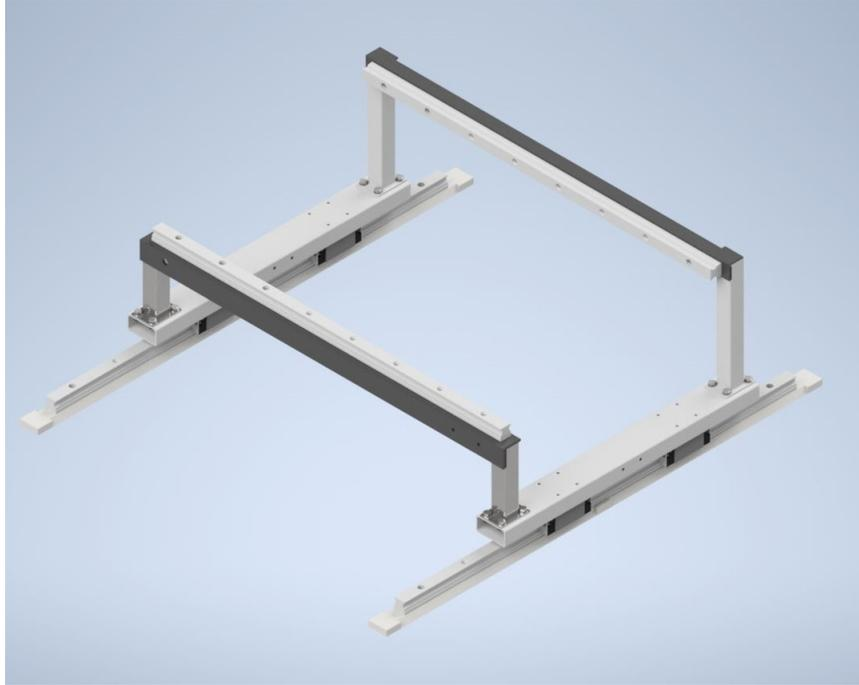
**Nota:** Diseño del sistema mecánico que permite el desplazamiento sobre el eje X.
