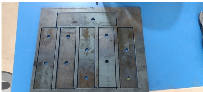
Figura. 35 Corte plasma de soportes para el motor.
