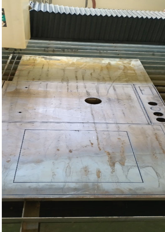
Figura. 36 Corte plasma de la base.
