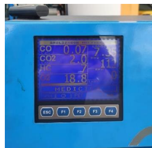
Figura 3: Toma de datos, gases a Ralentí. Fuente (Propio).
