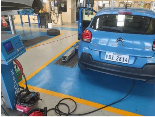
Figura 12: Toma de datos con B10 en el vehículo. Fuente (Propio).
