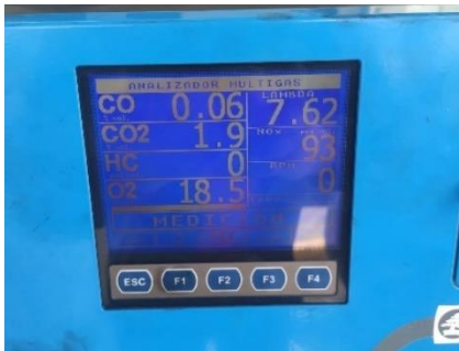
Figura 13: Toma de datos B10, ralentí. Fuente (Propio).
