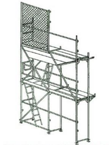
Figura 8. Esquema básico de andamio común [9].
