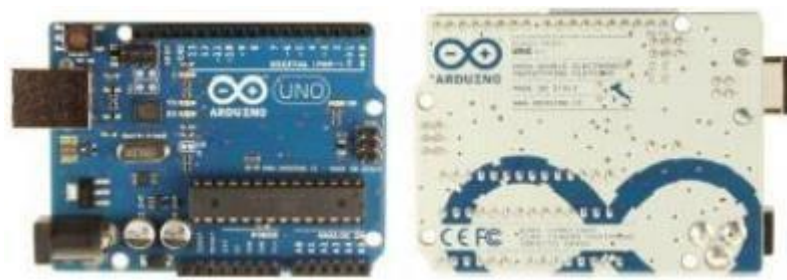
Figura 3. Parte frontal y reversa del modelo Arduino uno
