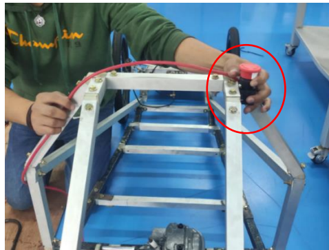
Botón de paro de emergencia externo [Autores]
