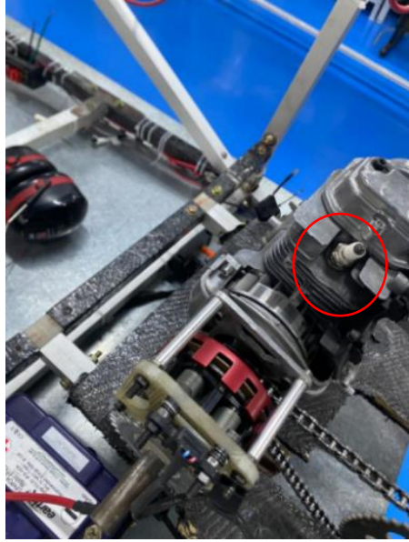
Bobina de encendido [Autores]
