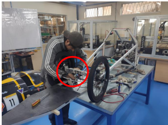
Montaje de módulo de radio de comunicación [Autores]
