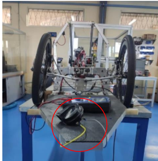
Montaje de Claxon [Autores]
