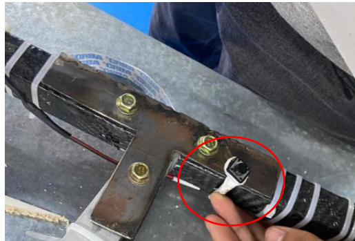
Montaje de botón Reset [Autores]
