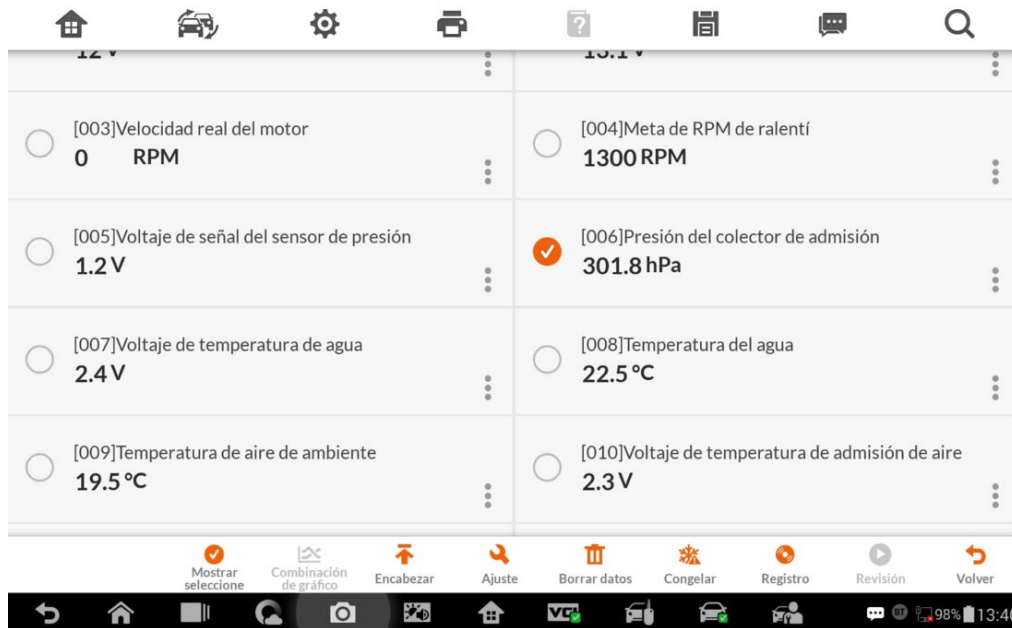
Análisis PID A1 (Presión absoluta del múltiple - MAP) desde Scanner Automotriz a tiempo real
