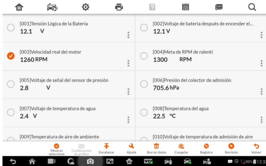
Análisis PID A0 (Revoluciones por minuto - CKP) desde Scanner Automotriz a tiempo real
