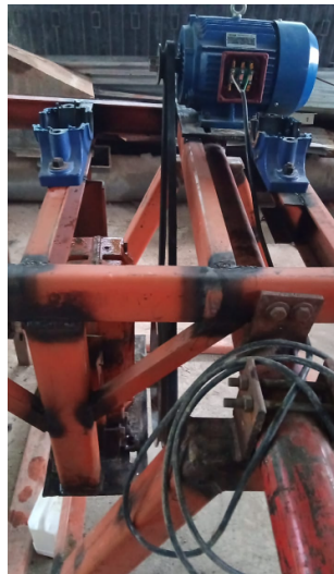
Figura 86. Base de motor plato granulador implementado [8]
