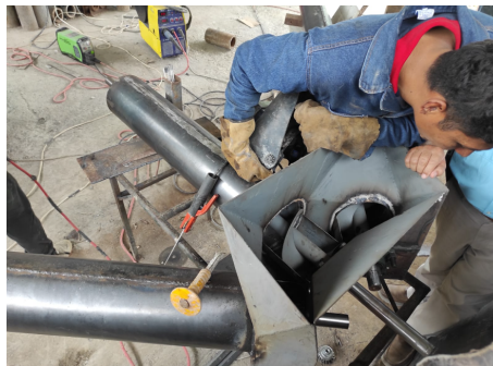
Figura 56. Instalación de tornillos sin fin en tubos [11]
