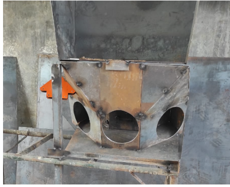
Figura 54. Compartimiento principal tolva dosificadora [11]
