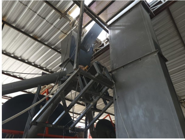
Figura 119. Elevador de cangilones y tolva dosificadora implementados [11]
