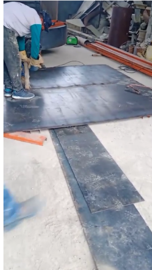
Figura 81. Corte de planchas para plato granulador [8]
