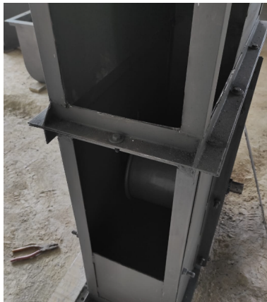
Figura 48. Ensamble de segmentos de elevador de cangilones [7]
