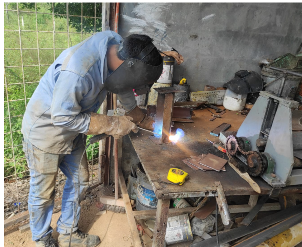
Figura 89. Construcción bastidor banda de salida [6]
