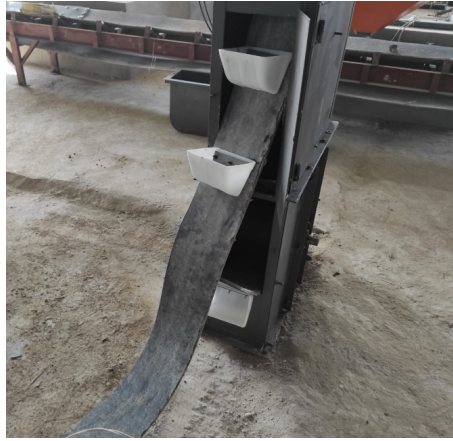
Figura 51. Instalación de banda con cangilones en elevador [7]
