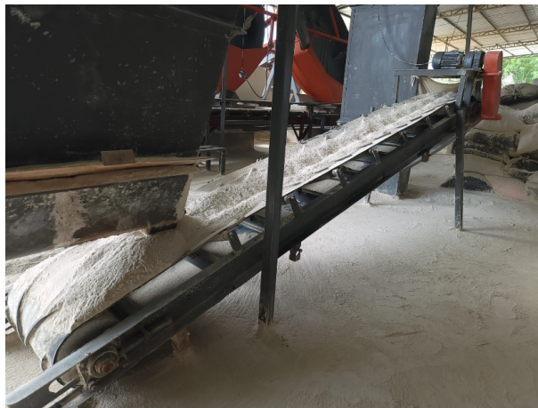
Figura 116. Banda alimentadora implementada [5]
