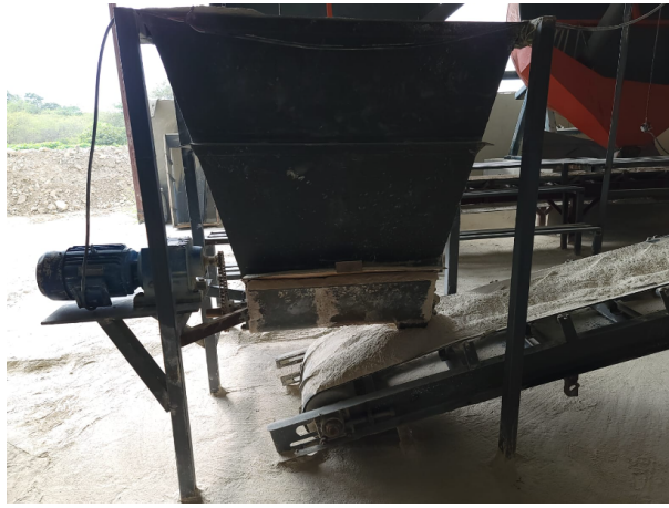
Figura 114. Tolva de alimentación implementada [10]
