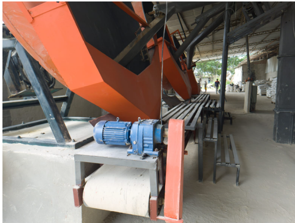
Figura 123. Banda de salida implementada [6]
