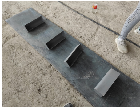
Figura 50. Colocación de cangilones en caucho de banda [7]
