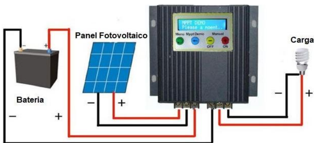
Figura 15. Conexión del controlador de carga
