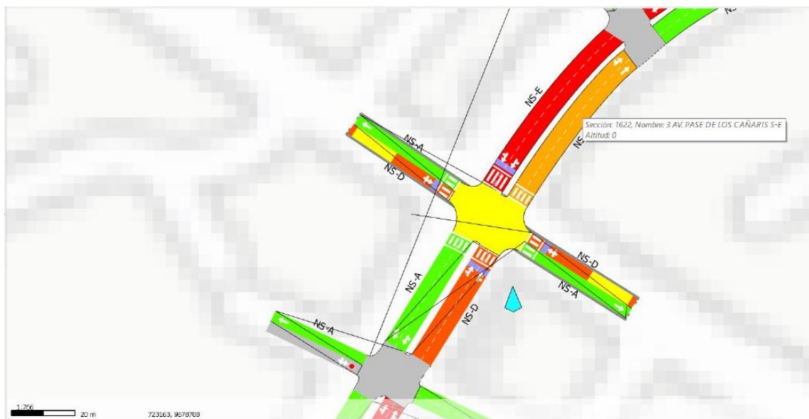
Ilustración 48. Niveles de servicio de la Intersección Avenida Paseo de los Cañaris y Avenida Viracochabamba para el año de 2043
