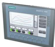
SIMATIC HMI, KTP700 Basic, Basic Panel, Manejo con teclado/táctil, pantalla TFT de 7", 65536 colores, Interfaz PROFIBUS, configurable a partir de WinCC Basic V13/STEP 7 Basic V13, incluye software Open Source, que se cede gratuitamente ver CD adjunto
